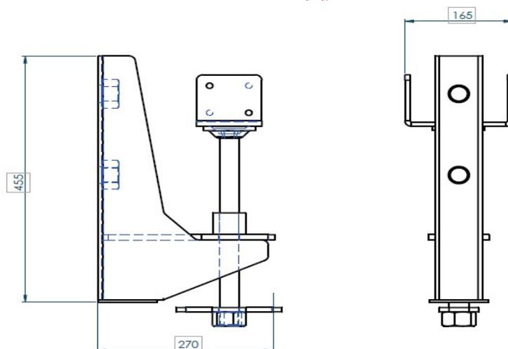
Les sabots de couloir permettent d'avoir des appuis en rive pour le coffrage des dalles ou pour la pose d'éléments préfabriqués, sans avoir d'emprise au sol ; idéal pour les zones avec un espace restreint. Ils offrent aussi des appuis pour les poutrelles dans des endroits difficilement accessibles avec des tours ou étais, à condition d'être le long d'un voile.
