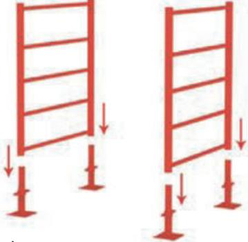
ÉCROUS DES VÉRINS POSITIONNÉS À LA MÊME HT
