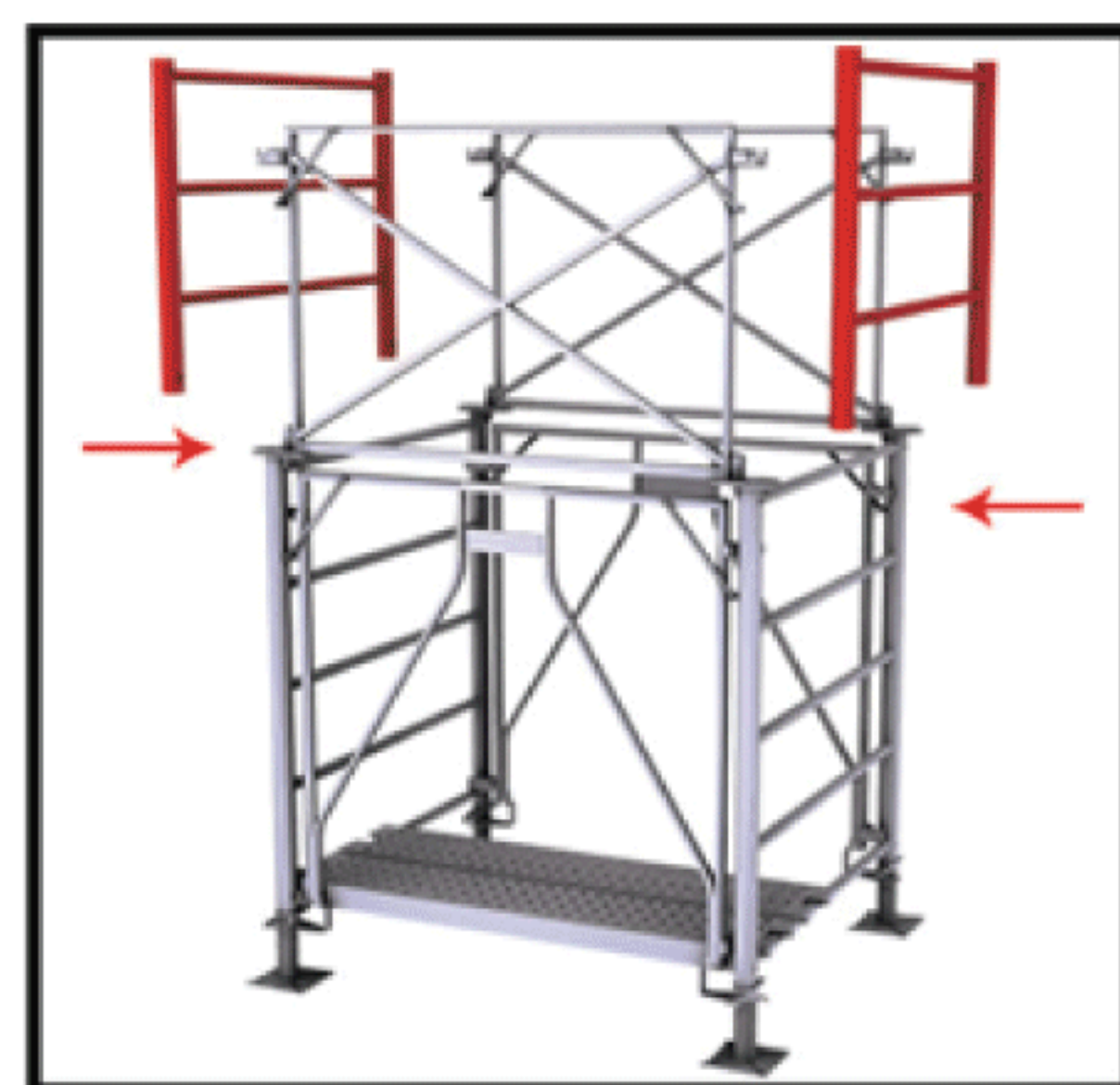
Montage depuis les plateaux de montage
