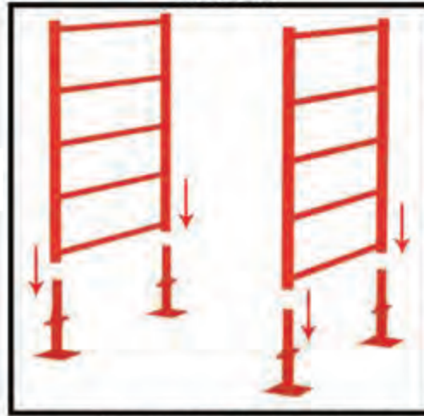
Ecrous des vérins positionnés à la même hauteur. Montage au sol
