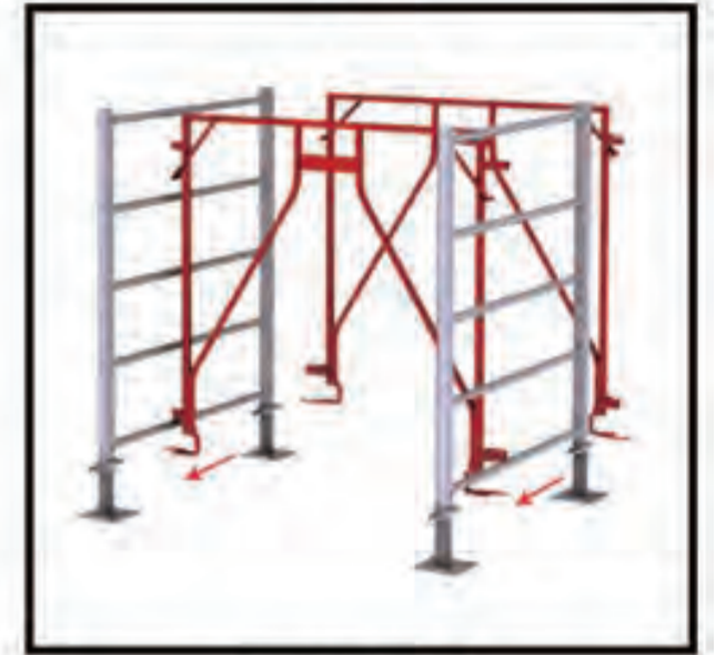
Montage au sol
